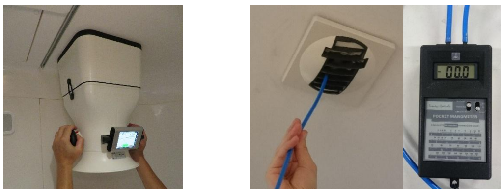
Figure 1. Photo du FlowFinder2 (à gauche) et du micromanomètre FC010 (à droite)
