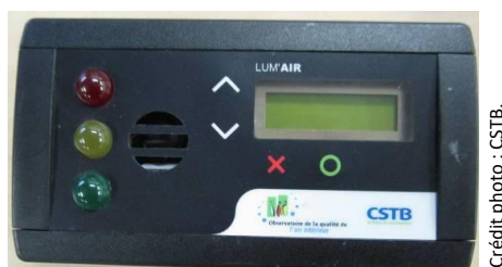
Figure 4. Lum’Air (version 2) pour la mesure du CO 2 développé au CSTB.
