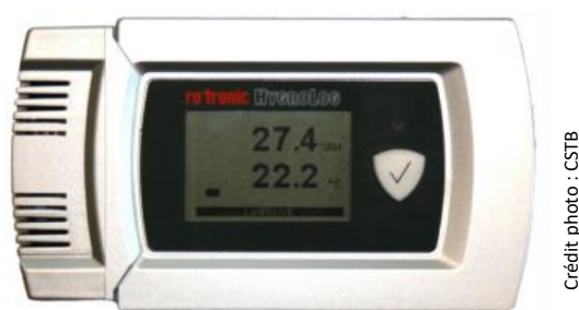
Figure 5. Appareil Hygrolog HLB20 (Rotronic ®) pour la mesure de la température et de l'humidité relative.
