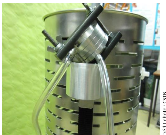
Figure 6. Tête de prélèvement pour les PM 2,5 .
