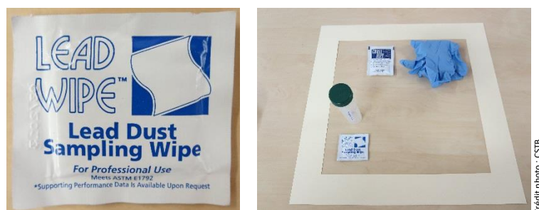
Figure 12. Matériel pour le prélèvement par lingette : lingette, gabarit de 0,12 m 2 , tube en polypropylène et gants.
