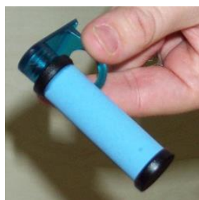
Figure 9. Corps diffusif Radiello® pour les aldéhydes (code 120-1).
