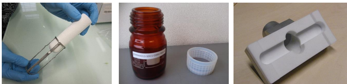
Figure 11. Matériel de prélèvement pour le passage de l'aspirateur : cartouche en cellulose, flacon brun et embout en Téflon.
