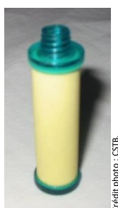
Figure 8. Corps diffusif Radiello® pour les COV (code 120-2).
