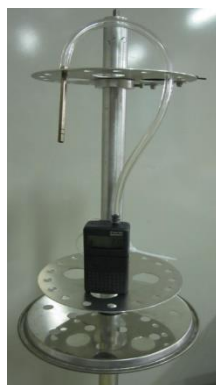
Figure 9. Prélèvement de COV par tube Tenax TA avec une pompe SKC Pocket
